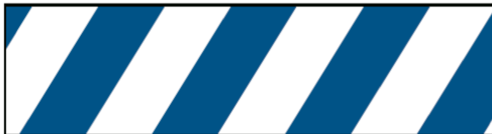
Combinación de color: azul de seguridad y blanco de contraste FIGURA 17 - Franjas de seguridad para indicar una instrucción obligatoria
