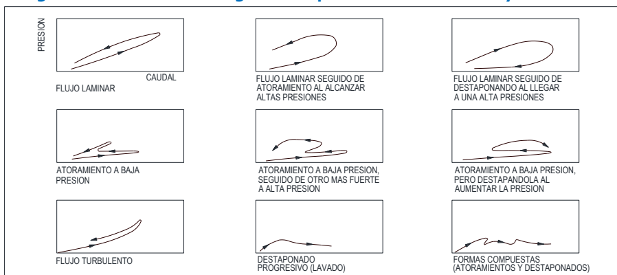
Figura 3.14 Se muestran gráficas típicas del ensayo de LUGEON
