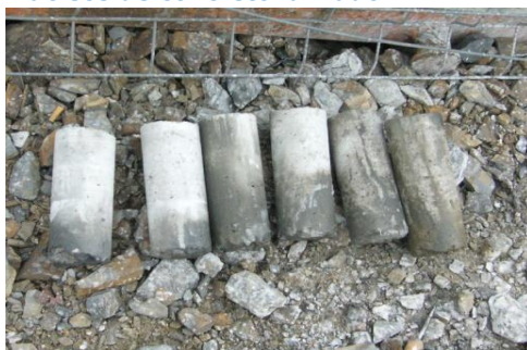
Figura 11.8 Extracción de núcleos de concreto lanzado
