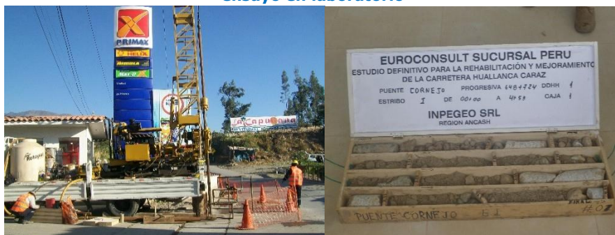
Figura 3.7 Caja fotografiada y con muestra parafinada para posterior ensayo en laboratorio
