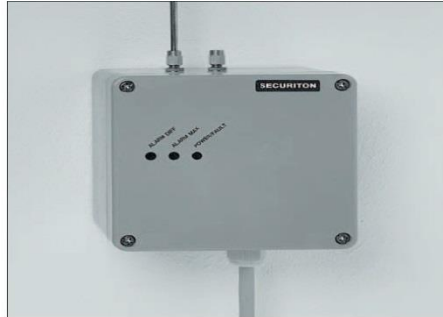
Figura 14.11 Detección por variación de presión
