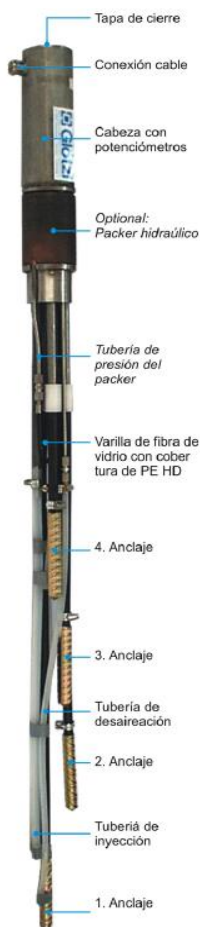
Figura 8.5 Esquema de un extensómetro de varillas
