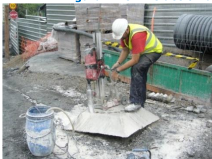
Figura 11.8 Extracción de núcleos de concreto lanzado
