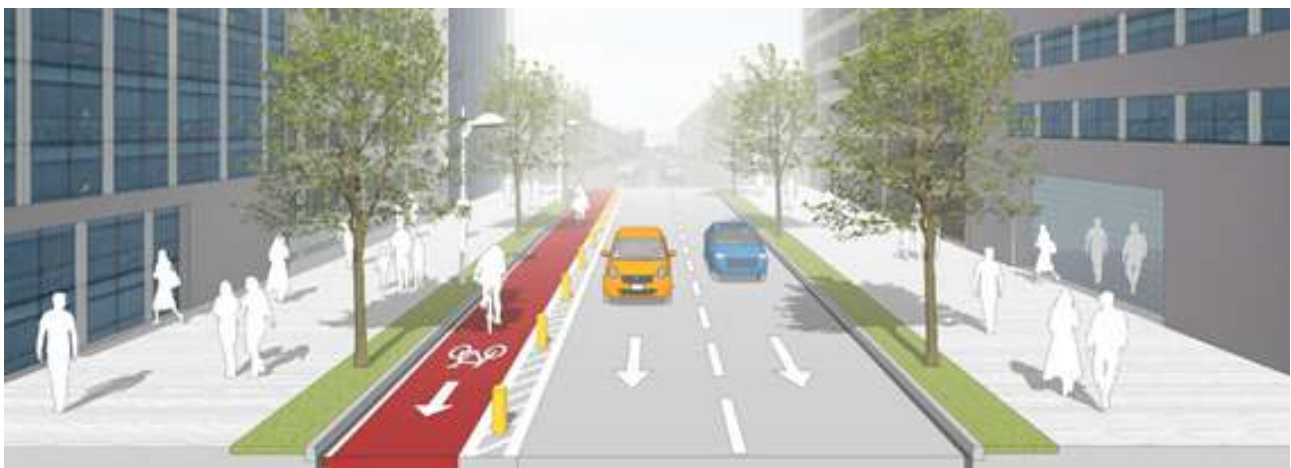
Vista de ciclovia unidireccional segregada adyacente a berma lateral
