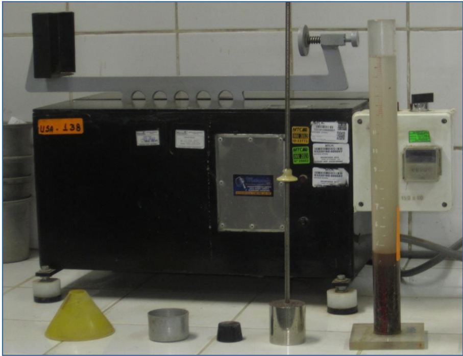
Figura 2 – Agitador mecánico y sus componentes
