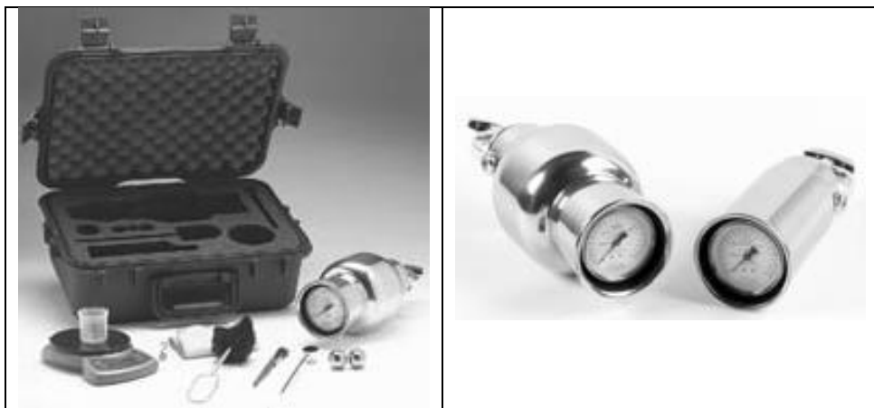
Figura 1: Medidor de humedad de gas a presión con Carburo de Calcio
