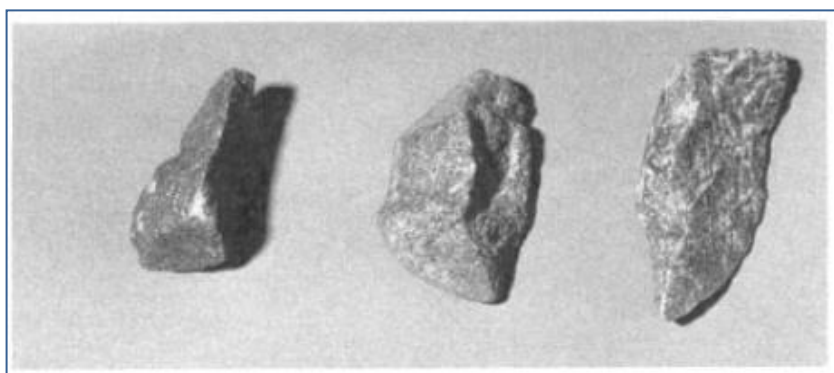
Figura: 2 Partículas Fracturadas (Bordes Agudos, Superficies Rugosas)
