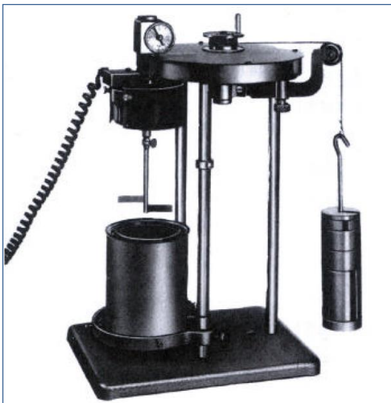
Figura 1. Viscosímetro Stormer con rotor tipo paleta y temporizador estroboscópico
