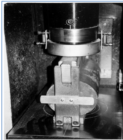
Figura 3. Cilindro colocado para ensayo de tensión indirecta
