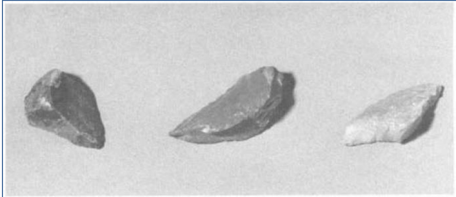
Figura: 3 Partículas Fracturadas (Bordes agudos, Superficies Alisadas)
