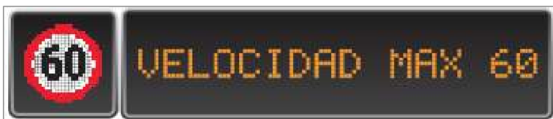
Figura 2.52 Ejemplo de una señal de una señal de mensaje variable luminoso de carácter informativo de una línea complementada con una señal reglamentaria de límite de velocidad como sistema inteligente de transporte
