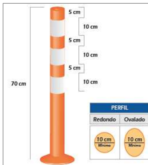
Figura 5.4 Ejemplo de un delineador simple con dimensiones.
